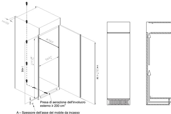
Il raccordo a parete e il retro del mobile da incasso devono essere dotati di un adeguato canale di dissipazione del calore
