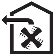
L'aria non deve essere scaricata in una canna fumaria utilizzata per lo scarico dei fumi di apparecchi a gas o altri combustibili (non si applica agli apparecchi che scaricano l'aria solo nel locale).
